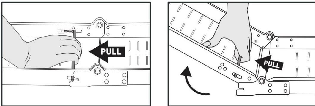
**FIGYELEM!** Beszorulás veszélye! A rámpát sík felületre kell fektetni. Használat előtt győződjön meg arról, hogy a kiálló perem szilárdan a lépcsőn vagy az emelvényen nyugszik, nem tud lecsúszni, és nem haladja meg a 60 cm-es maximális magasságot. A kocsiba történő berakodáskor ügyelni kell arra, hogy a tárgyak ne gurulhassanak el.
